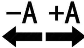
Richtungspfeil mit Markierung der gezählten Energie. Der Pfeil erlischt, wenn der Strom unter der Startschwelle liegt oder die Versorgungsspannung zu niedrig ist. Der obige Pfeil wird in Abhängigkeit von der Richtung des fließenden Stroms eingeblendet:
