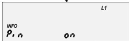
**PIN-Schutz:** Aktiviert („on“) bzw. aktiviert den PIN-Schutz: Dann sind alle Werte außer des kumulierten Wirkverbrauch durch PIN-Schutz vor unbefugtem Zugriff geschützt.
