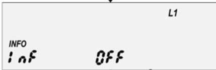
**Infoanzeige:** Aktiviert („on“) die permanente Anzeige der Momentanleistung. „OFF“ versieht sie mit einem PIN-Schutz.
