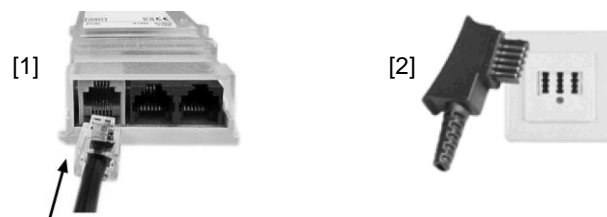
Abbildung 42: Anschluss an das Telefonnetz
