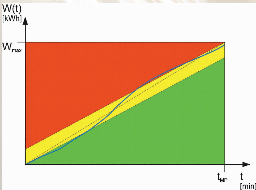
Beispielhafter Energieverbrauch einer Messperiode mit den Schalthandlungen der Maximum-Ampel MA3
