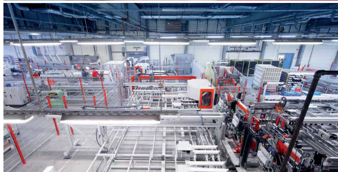
Hoch automatisierte Kunststofffensterproduktion im Hauptwerk in Meldorf
